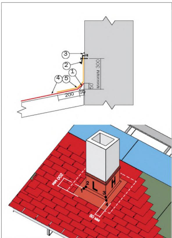
ся металлическим фартуком (2), который закрепляется механически и герметизируется силиконовым, тиоколовым или полиуретановым герметиком (3).
