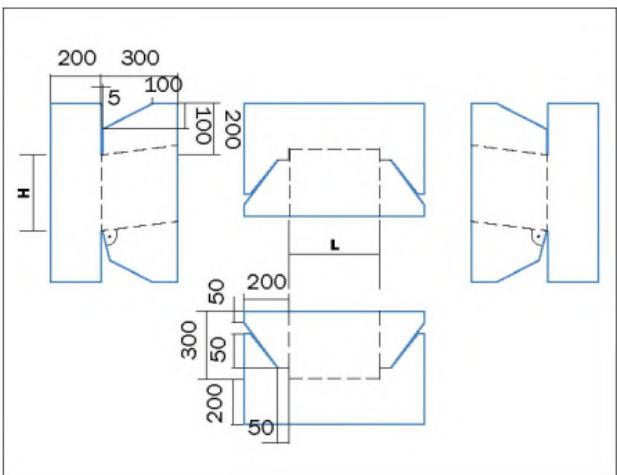
необходимо соблюдать принцип каскадности воды. Слева, справа и стыльной стороны необходимо выполнить желоб шириной 8 см. Места сопряжения рядовой черепицы следует проклеить битумной мастикой ТехноНИКОЛЬ в местах отсутствия самоклеящегося слоя на величину 10 см и отрезать уголки для отбоя воды.
